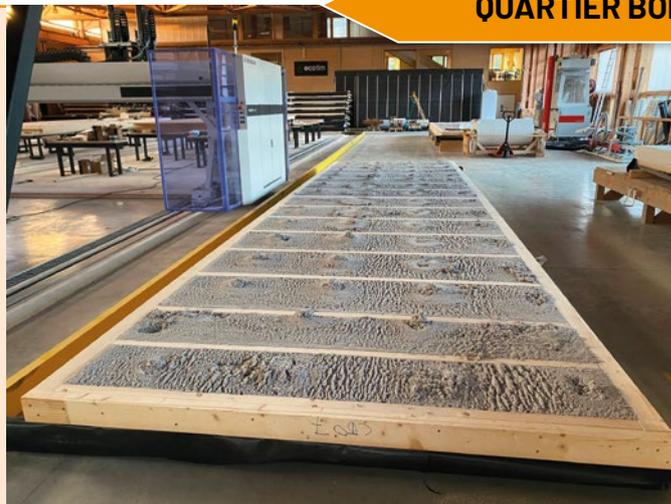
Les bâtiments en ossature bois utilisent quant à eux des montants de 60 x 140 mm avec isolation en ouate de cellulose, parement intérieur en OSB, et parement extérieur composé d'un panneau pare-pluie Agepan, d'un panneau de particules et d'un bardage vertical. Le lamellé-collé est également employé pour les planchers, avec une structure en solives surmontées d'un panneau OSB et d'une chape béton. L'ensemble repose sur un système poteaux-poutres combinant poteaux bois et poutres en lamellé-collé.
